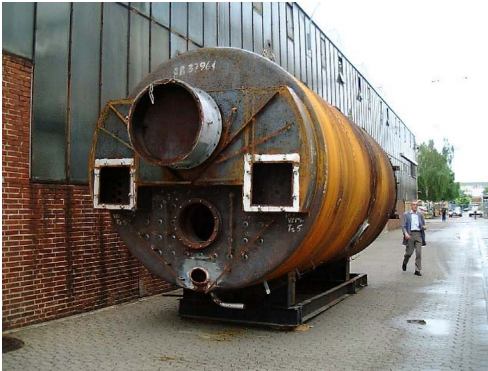
Einer der beiden veralteten Dampfkessel nach der Demontage
